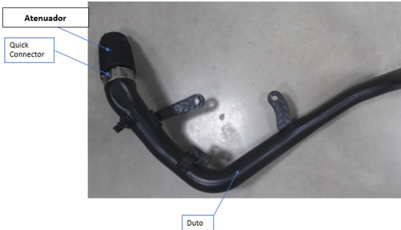
POSIÇÃO E FUNÇÃO DO ATENUADOR DE RUÍDO NO CONJUNTO
